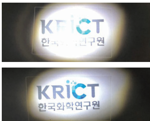
▲ [그림] 화학연의 반사방지 코팅을 적용한 필름은 기존 필름에 비해 바닥의 글자가 선명하게 보이는 효과를 나타낸다(좌). 화학연 롤투를 장비로 제작된 코팅소재의 투명도(우)
