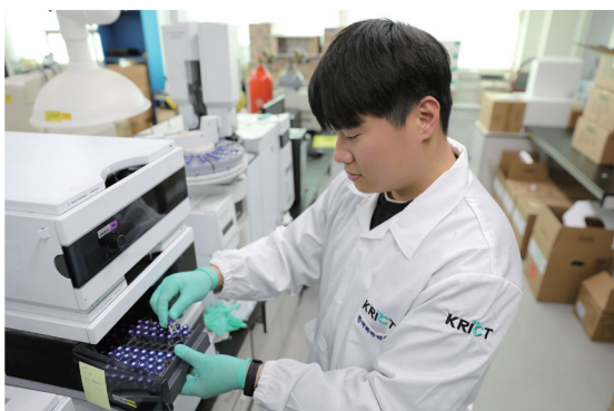
고성능 액체크로마토그래피(HPLC)로 테레프탈산이 갈산, 바닐릭산 등 최종 물질로 변환됐는지 확인하고 있다.
