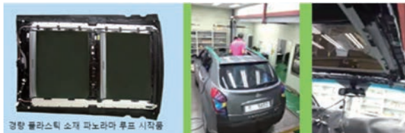
그림8. 경량 플라스틱 파노라마루프 제작 및 차량 장착
